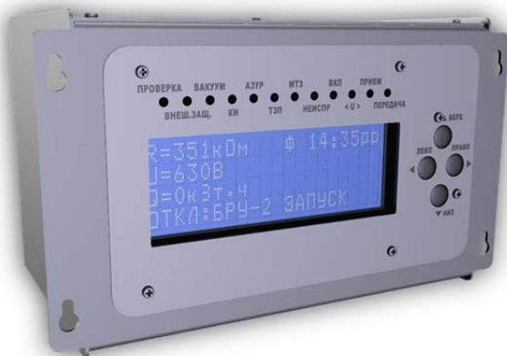
Блок предназначен для выполнения функций релейной защиты и автоматики, управления и сигнализации в составе взрывозащищенного электрооборудования, предназначенного для эксплуатации в подземных условиях шахт и рудников, в т.ч. опасных по газу (метану) и (или) угольной пыли.
