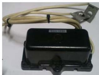
Блок ОПН предназначен для ограничения перенапряжений в коммутационных рудничных устройствах типа ПВИТ-М, ПВИ-400/250МВПП и др.
