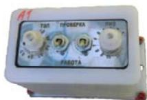
Предназначены для реализации защиты электрических сетей с изолированной нейтралью от токов короткого замыкания, а также для защиты от токов перегрузки. Встраиваются в пускатели ПВИТ-М, агрегаты шахтные пусковые АШТ-П, пускатели рудничные ПРН, устройства плавного пуска ПВИ-МВПП и др.
