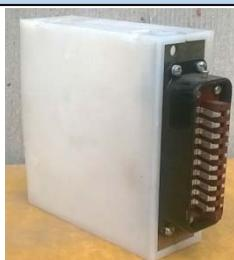
Предназначен для комплектации пускателя типа ПВИ-630МВ. Выполняет функции защиты от перегрева обмоток двигателя (позисторная защита), защиты от повреждений системы водяного охлаждения двигателей, контроля состояния изоляции отходящего присоединения, а также контроль наличия гальванической связи между присоединениями для двухскоростных двигателей.
