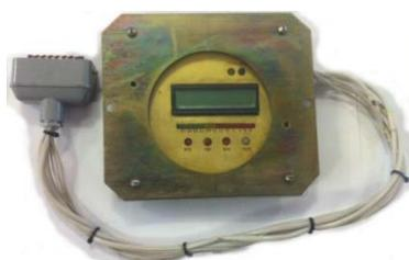
Предназначен для комплектации пускателя типа ПВИ-630МВ. Выполняет функцию оповещения обслуживающего персонала о режимах работы пускателя и осуществления интерфейса связи в режиме настройки.
