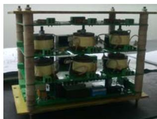
Предназначен для управления процессом плавного пуска в устройствах ПВИ-250МВПП, ПВИ-400МВПП. Дополнительно может комплектоваться вместе с соединительным жгутом.
