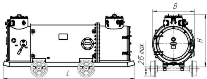
Рисунок — Габаритные размеры и массы подстанций
