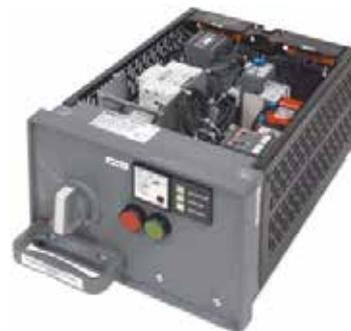
Система передвижения блоков с направляющими обеспечивает возможность использования тяжелого оборудования (максимальный вес блока — 30кг), а отсутствие вращающихся механизмов делает систему выдвижения исключительно надежной. Каждый блок работает на своего потребителя, и при его ремонте не требуется общего отключения НКУ.
